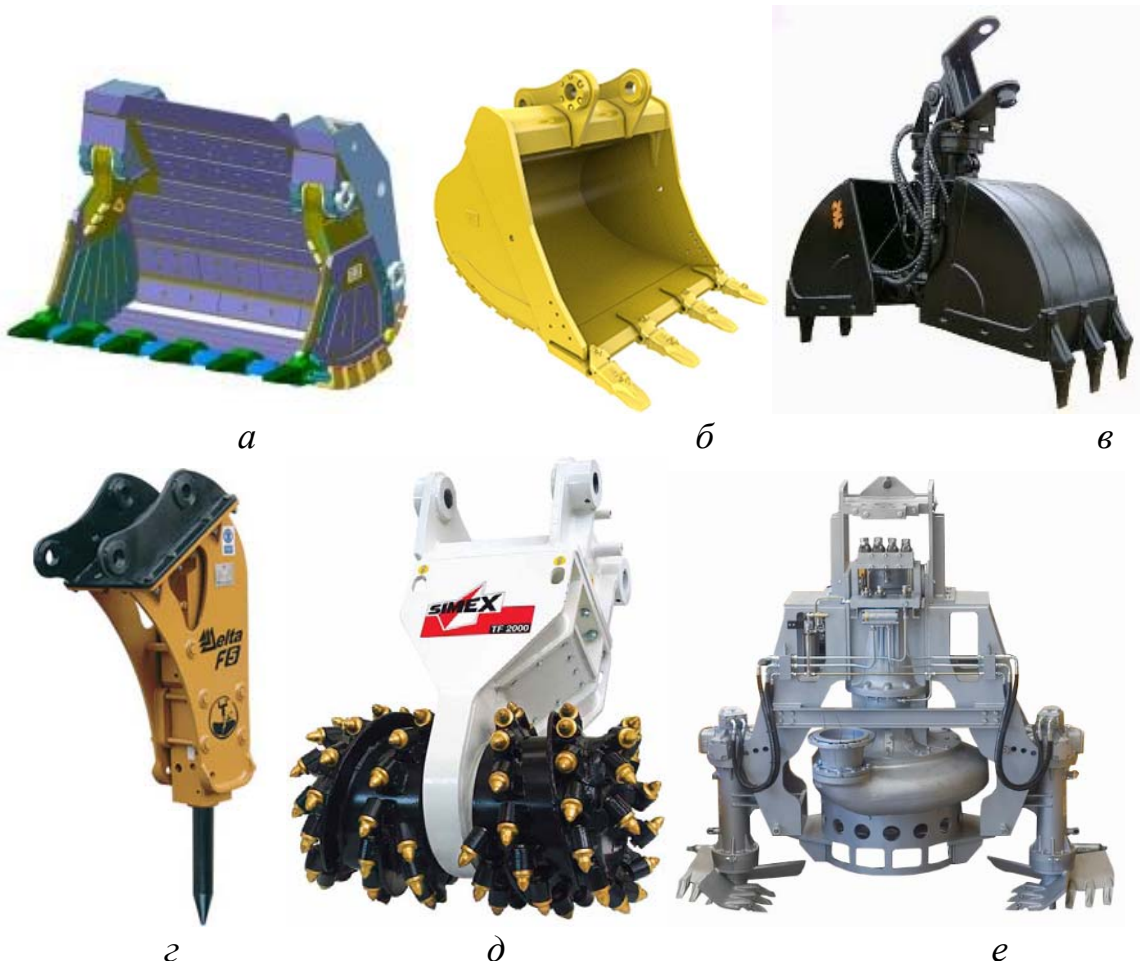
Рис. 3.16. Загальний вигляд робочого обладнання гідравлічних екскаваторів: а – ківш типу пряма лопата; б – ківш типу зворотна лопата; в – грейфер; г – гідромолот; д – фреза; е – ґрунтовий насос
