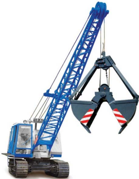
Рис. 3.20. Загальний вигляд екскаватора ЭО-4112-А-1 з грейфером
