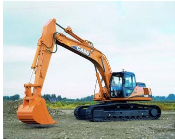
Рис. 3.4. Загальний вигляд гідравлічного екскаватора з одноківшевою прямою ( a ) та зворотною ( b ) лопатами
