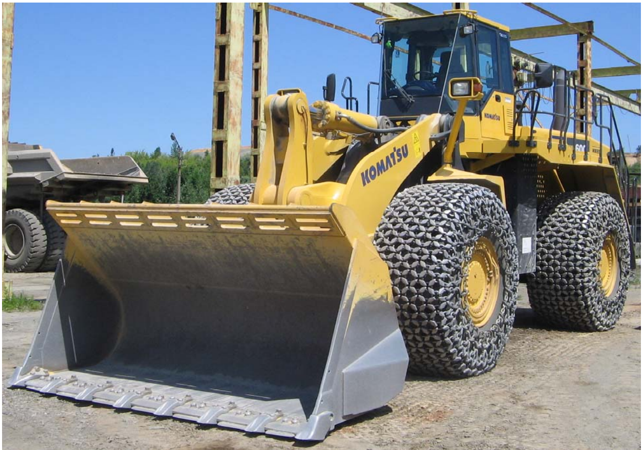
Рис. 4.9. Загальний вигляд одноківшевого фронтального пневмоколісного навантажувача для екскавації розпушених скельних порід у вибої
